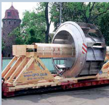
Turbine auf Welle für Wasserkraftwerk, Nettogewicht, ca. 35 Tonnen
