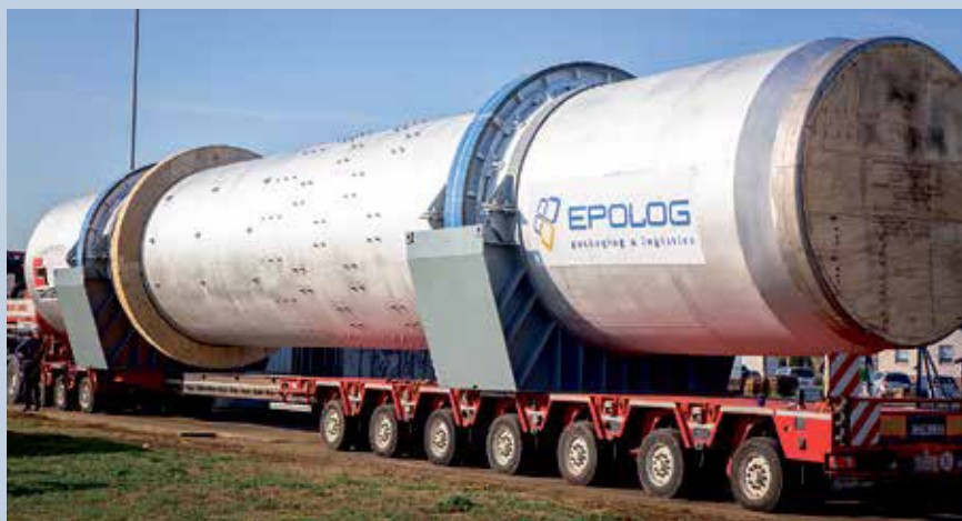
Drehrohrofen für Gipswerk in Bahrain, Nettogewicht ca. 132 Tonnen
